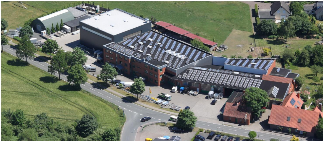
Großflächige PV-Anlagen auf Bestandsbauten
