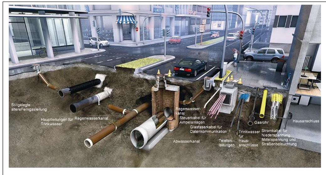
Abb. 3: schematische Skizze: Kanäle und Leitungen mit Hausanschlüssen
