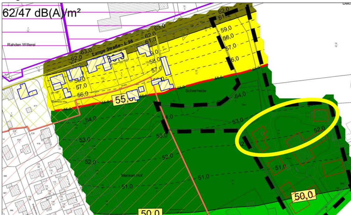
Abbildung 3: Beurteilungspegel (Gewerbelärm - Tag) für I-Ort-Höhe 8,00 m
