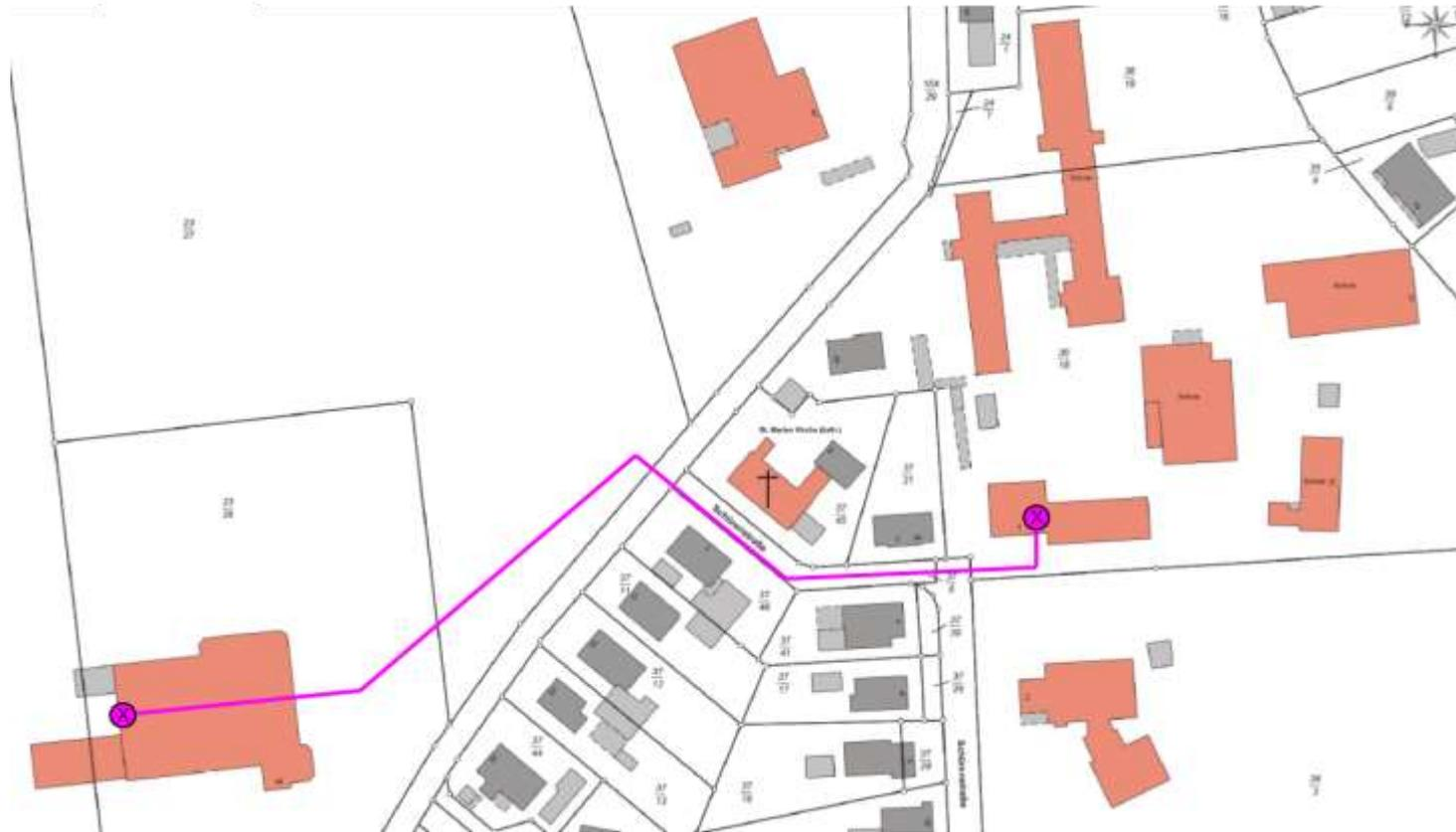
Wärmeleitung 250 m erdverlegt + 50 m kellerverlegt
