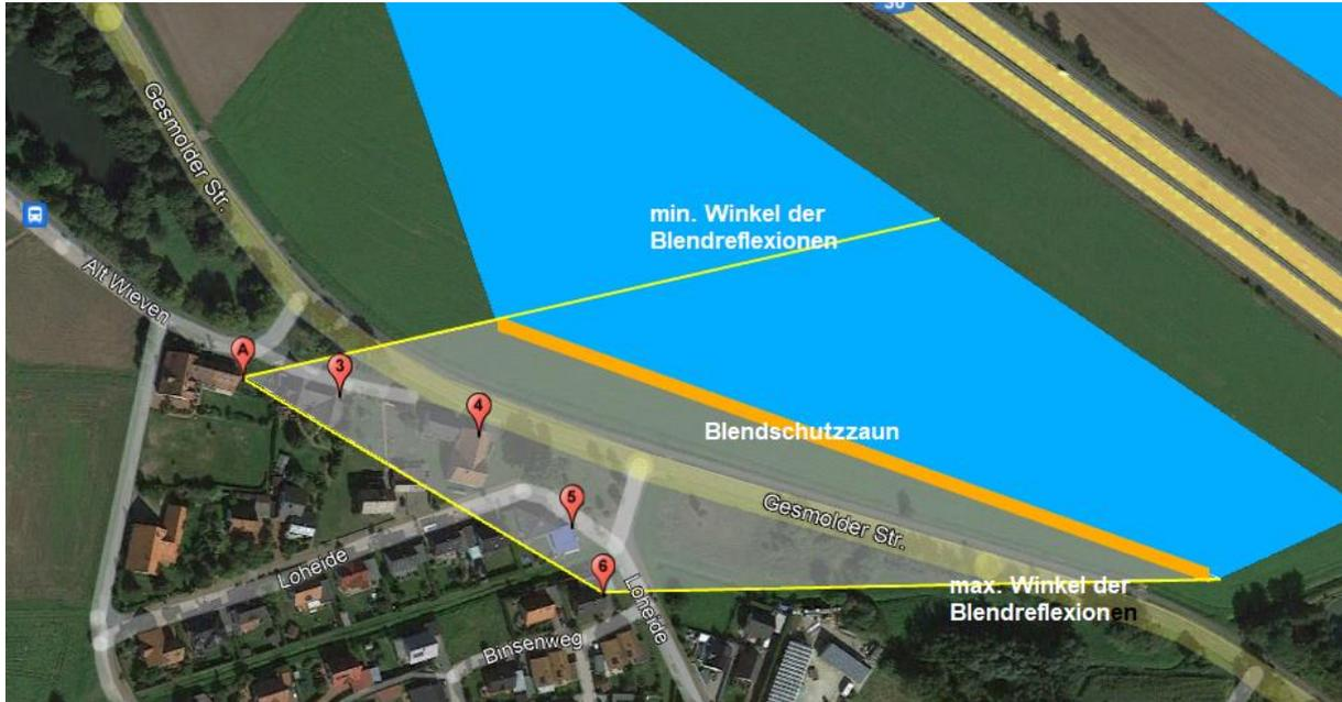
Abbildung 30: PV-Feld A (Blau), Blendreflexionen des Solarparks (gelb), relevanter Bereich (weiß) der Wohngebäude und ermittelte Länge des Blendschutzzauns (orange)
