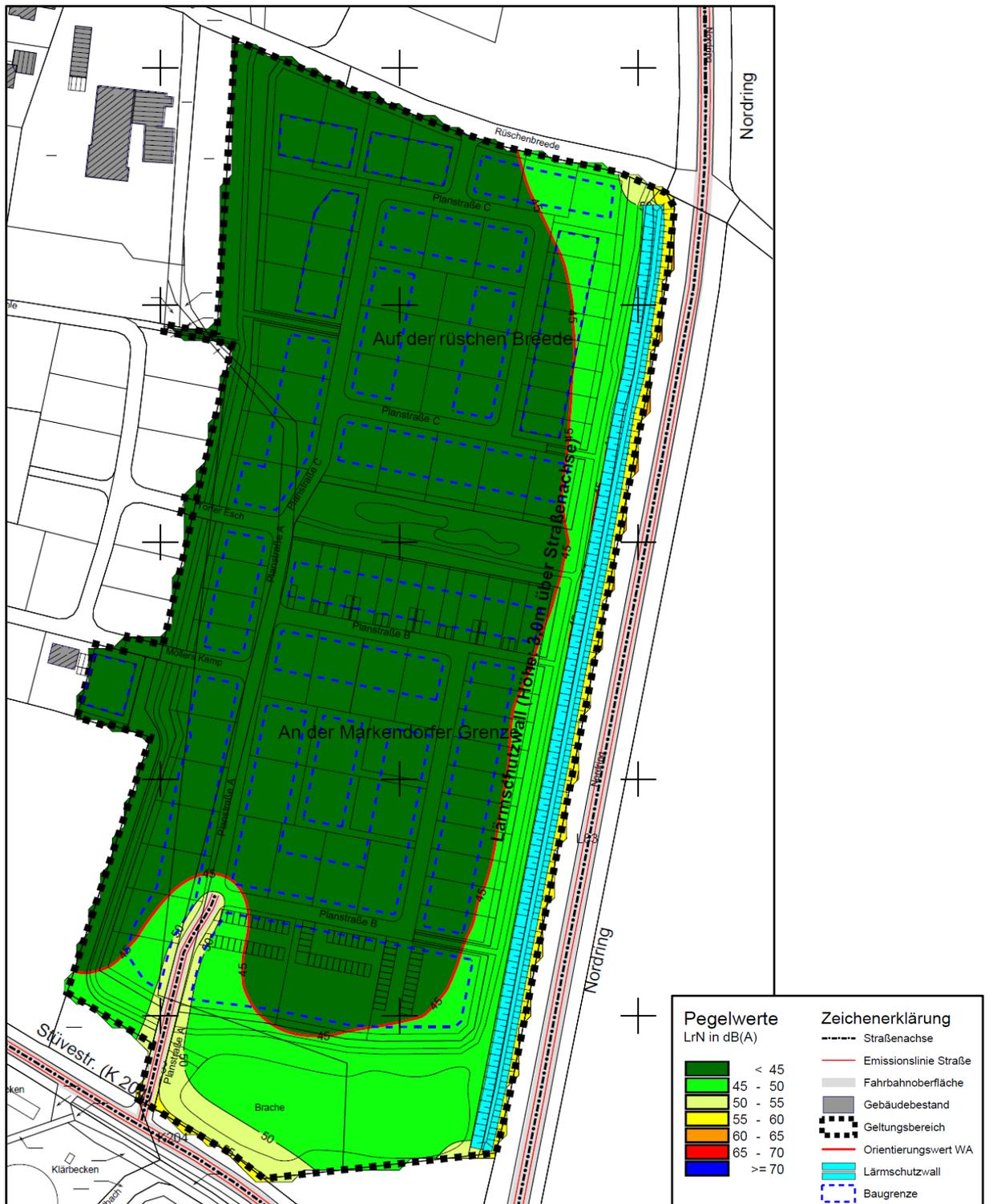
Bild 6: Isophonenkarte Nacht für Erdgeschoss und Terrassen mit Lärmschutzwand (3,0 m)
