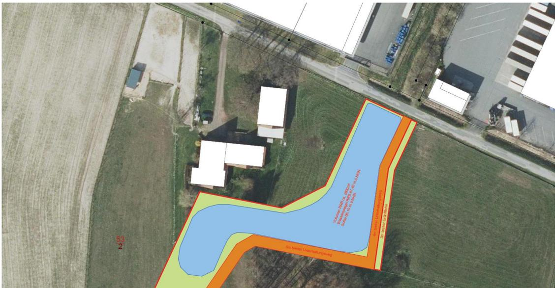
Abbildung 5: B.-Plan GG Bruche Ost, Regenrückhaltung EZG Ost und EZG Mitte
